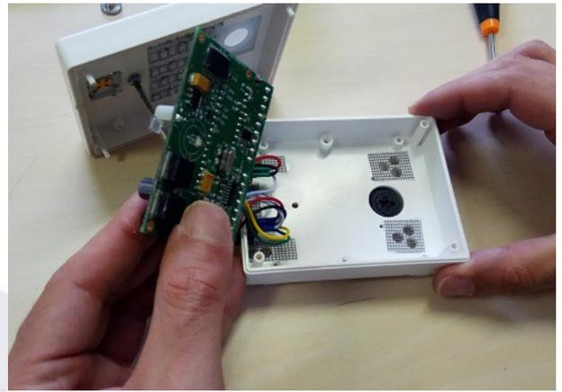
Es muy importante mantener **protegida la parte superior del CW que contiene los sensores de lluvia e IR** durante todo el tiempo en el que manipulamos la unidad. Bastará con mantenerlos apoyados en una tela suave o una servilleta de papel.
