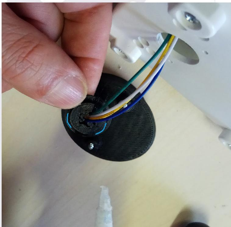
Coloque el sensor en posición, fije la pieza redonda en el orificio y **atornille el sensor** con firmeza en la caja.
