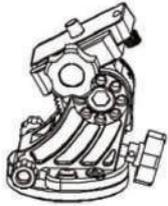
**Trípode sin cabezal:** Extienda las patas del trípode hasta una altura que permita a la **Star Adventurer** trabajar con estabilidad y seguridad. Rosque en el tornillo superior del trípode la cuña ecuatorial o la montura **Star Adventurer** (Fig. 4)
